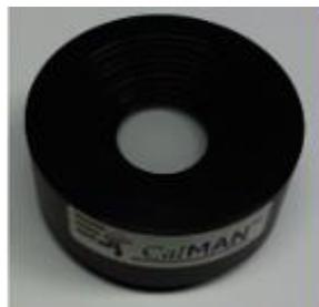
*Figure 3. K10-A cosine diffuser.*
